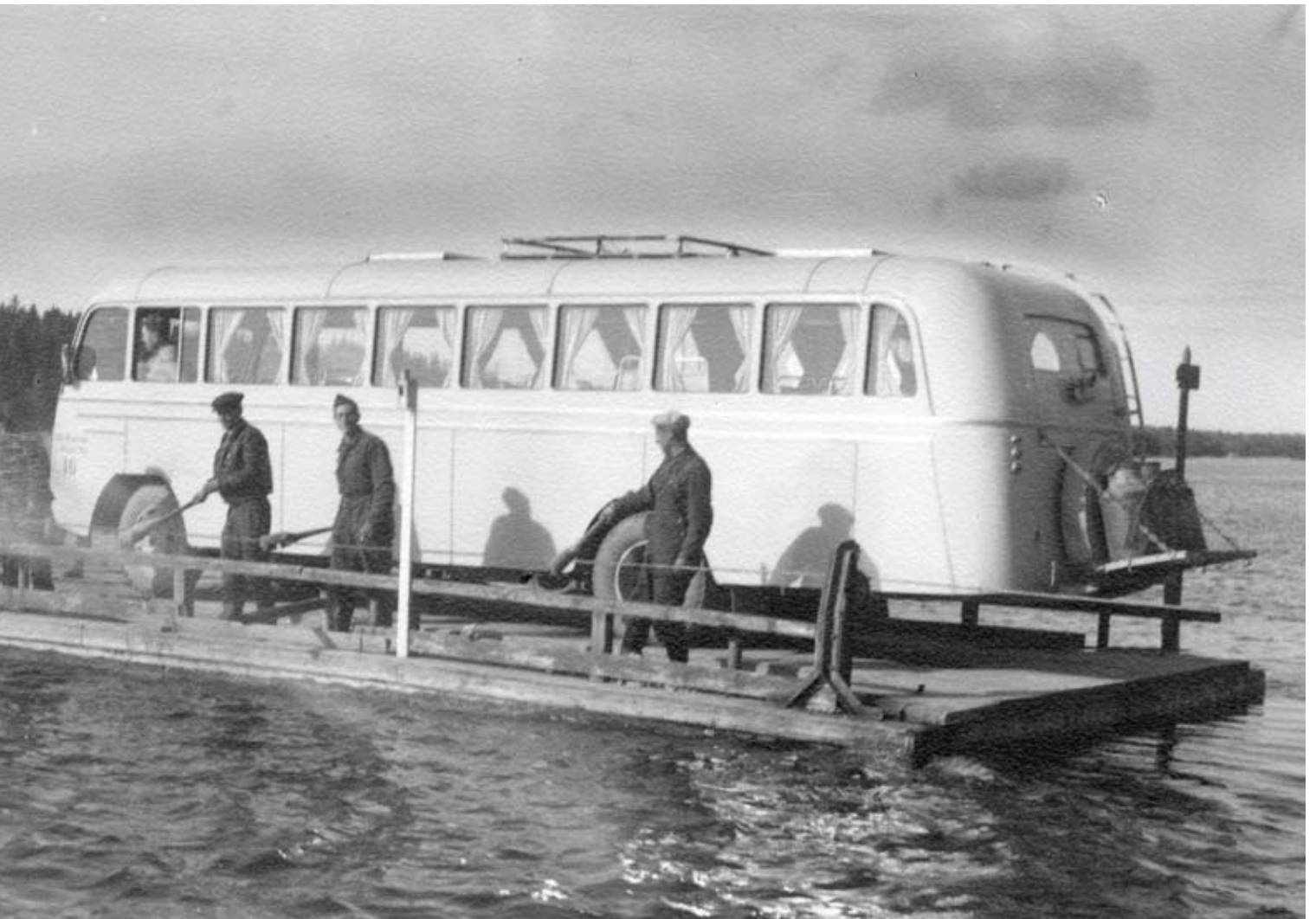
Viikinki-Volvo Hellnäsin salmen (Hellnässund) kapulalossilla Vöyrissä. Miehet vetävät kapulalossia puukapuloiden avulla kohti vastarantaa. Vöyrin saariston maidot kuljetettiin linja-autotakelineellä mantereelle Kaitsorin meijeriin. Auto on Haldin & Rose Ab no: 16 eli yrityksen suosimista 1950-luvun Boxer-Volvoista. Kuva: Svenska Litteratursällskapet i Finland. Kuvaaja: Erik Hägglund.
